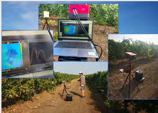
Figura 1. Sistema portatile di imaging iperspettrale SWIR
